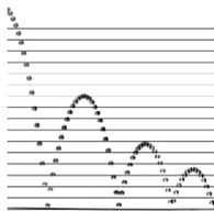
6. Используя стробоскопическую фотографию подпрыгивающего шарика, определите, во сколько раз уменьшается скорость шарика при ударе о поверхность.
